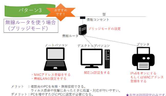
図7：構成パターンと機器の設定の説明
